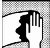
**Очистка поверхности;** удаление загрязнения поверхности перед шлифованием с использованием очистителя **A1 AS 700**
